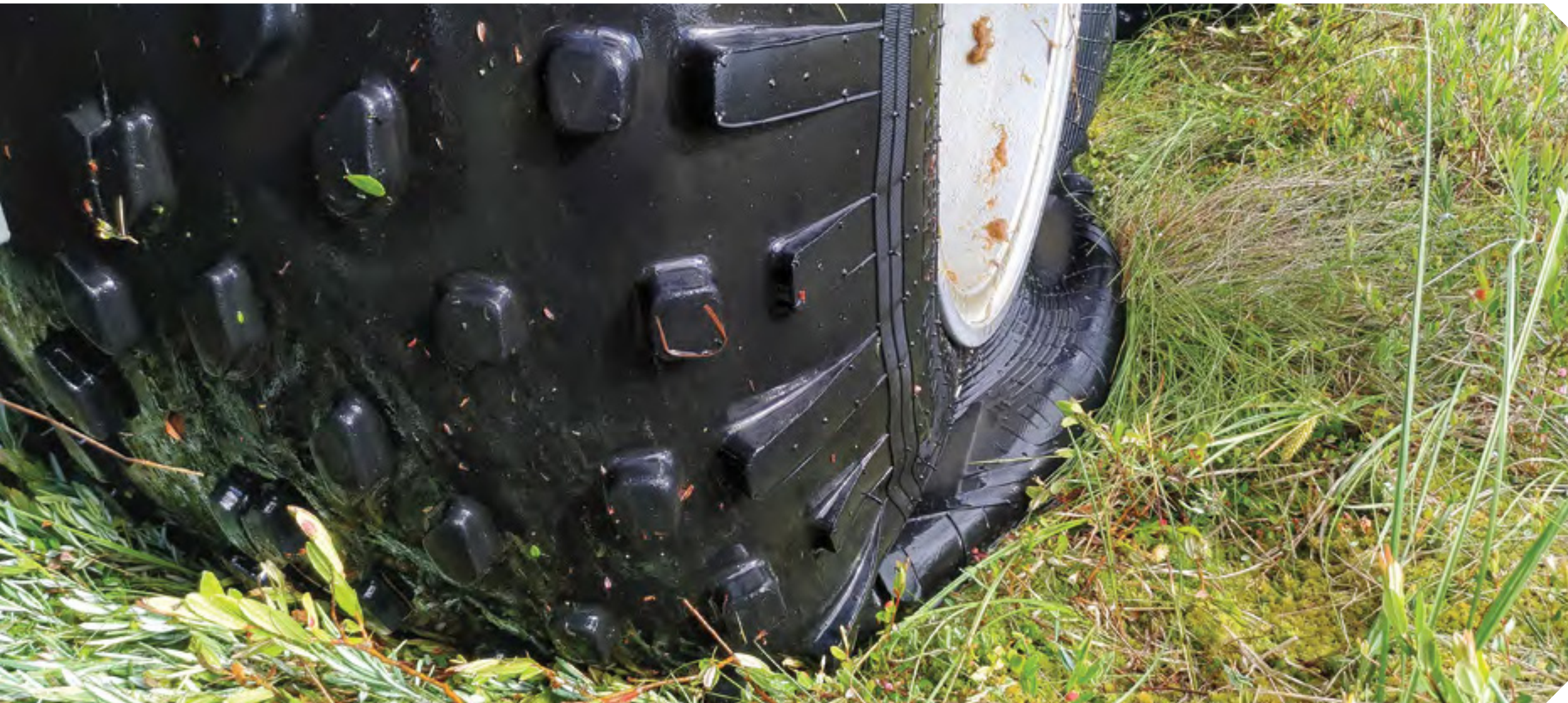
Шина AVTOROS MAX-TRIM в режиме «Болото», давление 0,05 атм
